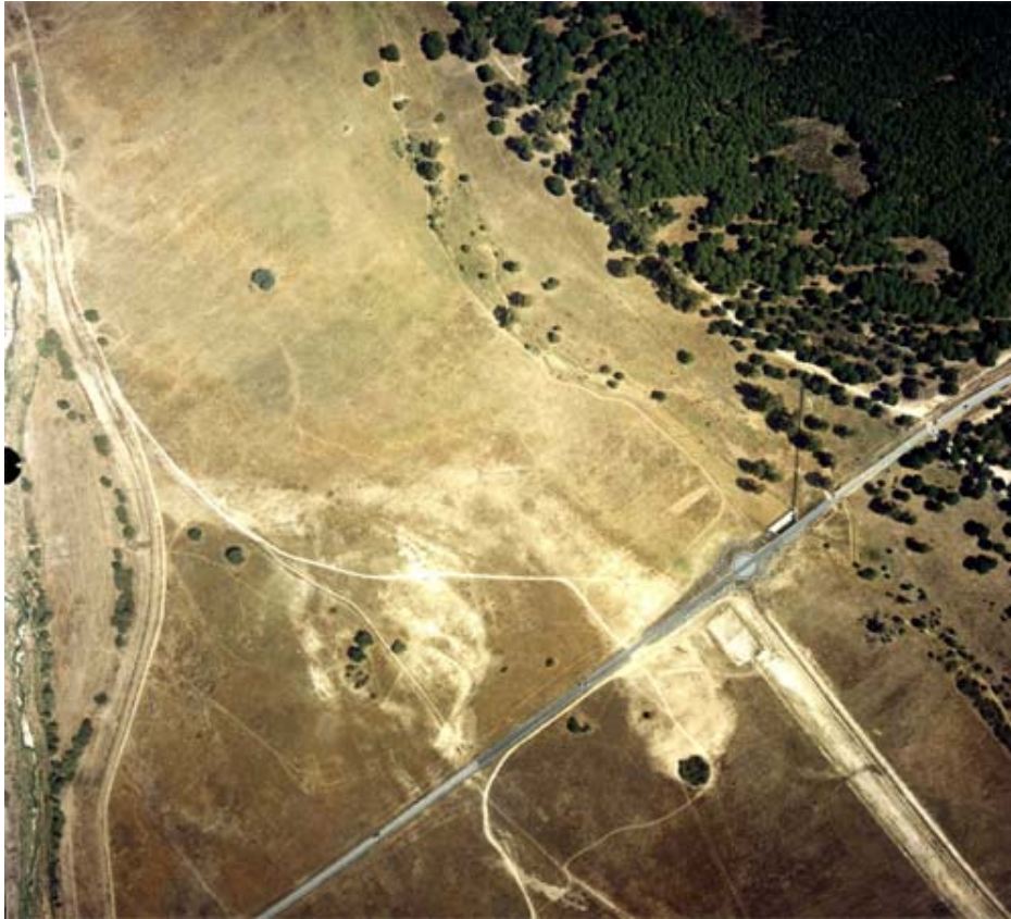
Figura 5. Zona central del área de inundación-laminación-sedimentación asociada al reparto de caudales de avenida entre los arroyos del Partido y de la Cañada del Pinar y ubicada en el espacio comprendido entre ambos. En primer término destaca el camino que une El Rocío con Villamanrique, que en situaciones de avenidas su zona de cotas más bajas puede funcionar como umbral de vertido. También se aprecia el DIQUE 2 construido sobre el arroyo de la Cañada del Pinar, inmediatamente aguas arriba del puente sobre dicho arroyo del camino que se ha comentado (en la rotonda de la fotografía). A la izquierda de la fotografía se observa la nueva mota construida en el margen izquierdo del arroyo del Partido, desde la ubicación del DIQUE 1 hasta el mencionado camino-umbral de vertido. En el extremo superior izquierdo de la fotografía se aprecia el ala lateral izquierda del vertedero frontal del DIQUE 1 y su vertedero lateral en toda su longitud.
