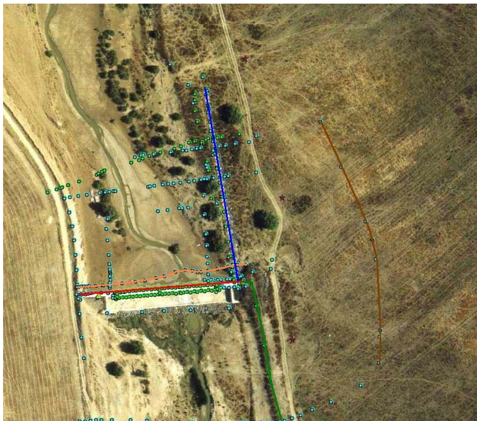
Figura 4. Vista en planta del dique construido en el arroyo del Partido aguas abajo de la casa de la Matanza sobre una fotografía aérea de agosto de 2008 (con el perfil de su vertedero frontal original de 2006). Sobre el mismo aparecen los puntos obtenidos con los diferentes levantamientos topográficos realizados en el propio dique y su entorno en los años 2007 (con una estación total, en azul) y 2008 (con un DGPS, en verde). También aparecen: a) la línea roja que muestra la posición del vertedero frontal del dique; b) la línea azul que define al vertedero lateral del mismo; c) la curva en marrón que representa el perfil del terreno en el área de inundación-sedimentación, inmediatamente aguas abajo del vertedero lateral; d) la línea en naranja que establece el perfil levantado a una sección del cauce, aguas arriba del dique; e) la línea en verde oscuro que representa la dirección de la nueva mota construida en el margen izquierdo del arroyo del Partido, aguas abajo del dique, para separar la superficie de inundación-sedimentación del cauce del arroyo.
